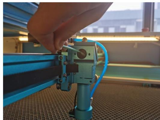
第三反射鏡在雷射頭的上面。
